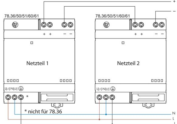
Parallelschaltung für erhöhten Strom (nur 78.51/61)
