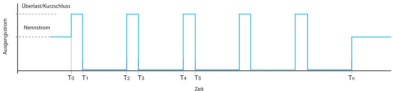
Unter normalen Bedingungen liefert das Schaltnetzteil der Serie 78 den von der Last geforderten Strom.
