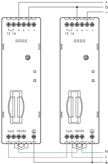
Parallelschaltung für erhöhten Strom
