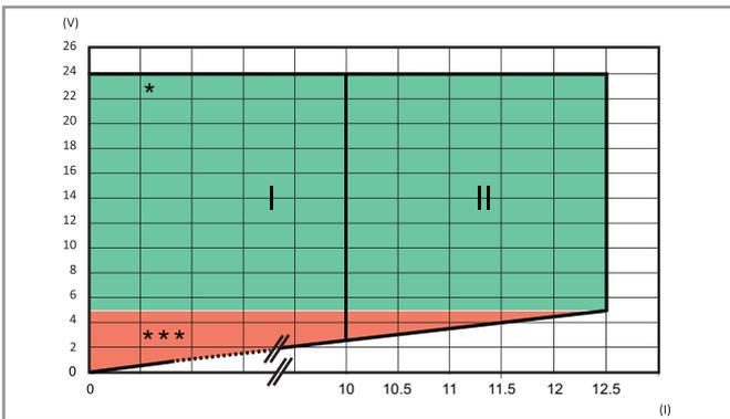
I: Ausgang bei Umgebungstemperatur bis zu 50 °C
