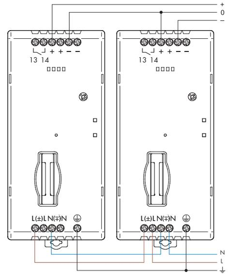
Parallelschaltung für erhöhten Strom
