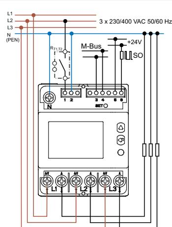
R<sub>T1,T2</sub> = Rundsteuerumschaltgerät
