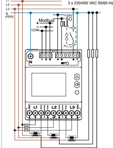
R<sub>T1,T2</sub> = Rundsteuerumschaltgerät
