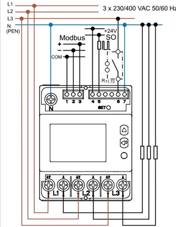
R<sub>T1,T2</sub> = Rundsteuerumschaltgerät
