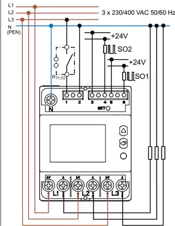
R<sub>T1,T2</sub> = Rundsteuerumschaltgerät
