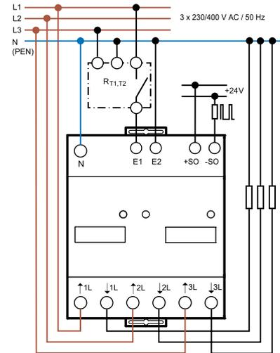
R<sub>T1,T2</sub> = Rundsteuerumschaltgerät bei geschlossenem Kontakt wird der Tarif 2 gezählt
