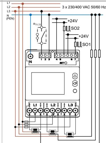
R<sub>T1,T2</sub> = Rundsteuerumschaltgerät
